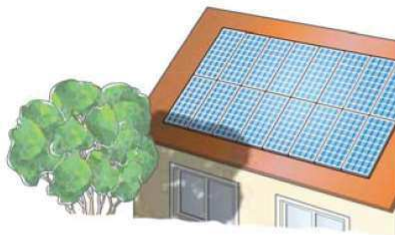
Schattenwurf auf 4 Module Insgesamt betroffen sind 7 Bypassdioden
