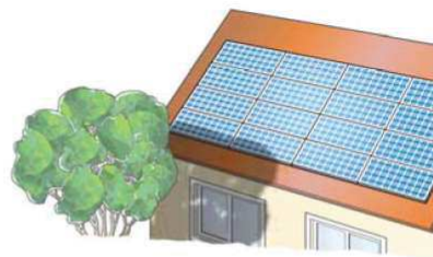
Schattenwurf auf 2 Module Insgesamt betroffen sind 2 Bypassdioden
