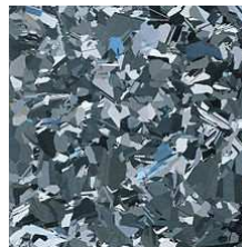
Polykristalliner Wafer vor und nach der Anti-Reflex-Behandlung der Licht-Oberfläche
