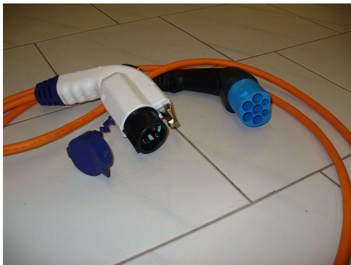
Ladekabel für Elektrofahrzeuge, netzseitig mit „Mennekes-Stecker“ (Typ 2), autoseitig SAE J1772–2009 (Type 1) bis 3,3 kW
