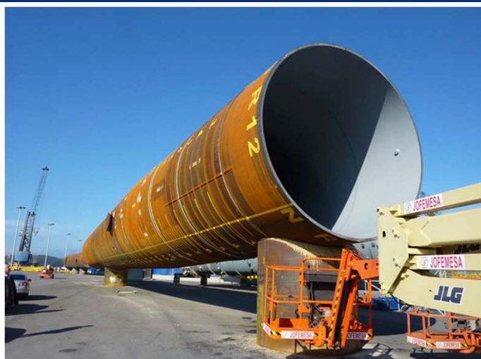
Fertiger Riffgat-Monopile auf dem Gelände des spanischen Herstellers IDESA (Foto: IDESA)
