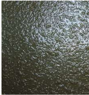
Hier entsteht Biogas: Oberfläche des Gärsubstrats im Fermenter einer Biogasanlage.
