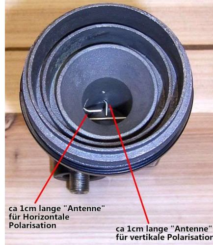
Blick in das Feedhorn eines Single Universal LNB
