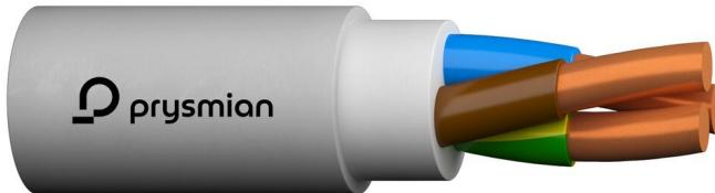
ECONYM500 eignet sich gleichermaßen für Gebäude und Industrie. Die Verlegung kann im und unter Putz in trockenen, feuchten und nassen Räumen sowie in Beton, ausgenommen in Schüttel-, Rüttel- oder Stampfbeton erfolgen. ECONYM500 lässt sich im Freien verlegen, solange sie vor direkter Sonneneinstrahlung geschützt ist. Nicht zur Verlegung in Erde oder Wasser geeignet.
