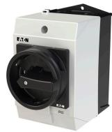
**Hauptschalter, T0, 20 A, Aufbau, 4 Baueinheit(en), 6-polig, 1 S, 1 Ö, HALT-Funktion, mit schwarzem Drehgriff und Sperrkranz, abschließbar in 0-Stellung**
